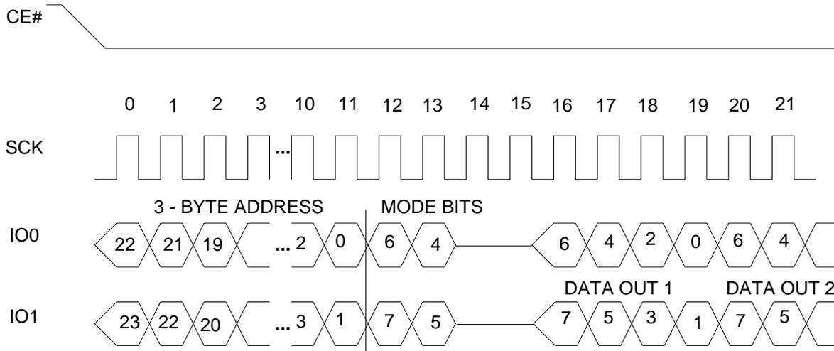
**FRQO COMMAND (FAST READ QUAD OUTPUT) OPERATION**
